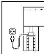
Pre vašu vlastnú bezpečnosť odporúčame vytvoriť s pripájacím káblom odkvapkávaciu slučku, ktorá zabráni prípadnému stekaniu vody pozdiž kábla do sieťovej zásuvky.
