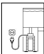
圈，这样可以防止水沿着导线流入插座。
