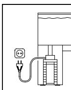
Para su propia seguridad se recomienda el formar un lazo de goteo con el cable de conexión para evitar que el agua que fluya a lo largo del cable pueda llegar a la toma de corriente.
