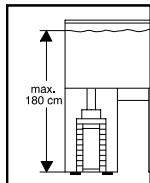
La alegerea locației de amplasare a aparatului se va avea în vedere înălțimea de instalare. În vederea siguranței optime în funcționare, distanța dintre suprafața apei și baza filtrului va fi de max. 180 cm. Deoarece la prelucrarea lemnului sunt utilizate numeroase materiale de vopsire și şlefuire, picioarele aparatului pot lăsa urme vizibile pe mobilă sau parchet. Din acest motiv aparatul nu se va amplasa fără protecție pe suprafețele de lemn. Filtrul se va utiliza numai în poziție verticală.
