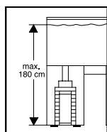
Au moment de choisir l'emplacement de votre appareil, tenez compte de la hauteur d'installation. Afin d'obtenir une sécurité de fonctionnement optimale, une distance maximale de 180 cm entre la surface de l'eau et le fond du filtre doit être respectée.
