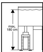
Beakta monteringshöjden när du väljer plats för enheten. För att uppnå bästa funktion får avståndet mellan vattenytan och filterbotten endast vara 180 cm.
