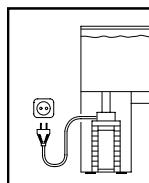
Zu Ihrer eigenen Sicherheit empfiehlt es sich, mit dem Anschlusskabel eine Tropfschlaufe zu bilden, die verhindert, dass evtl. am Kabel entlang laufendes Wasser in die Steckdose gelangt.
