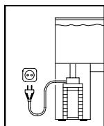
Med henblik på egen sikkerhed anbefales det at lave en dråbeløkke på strømtislutningskablet for at forhindre, at vand, der løber hen ad slangen, når stikdåsen.
