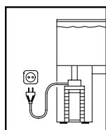
Nous recommandons, pour votre sécurité, de former une boucle d'égouttement avec le câble de raccordement, permettant d'éviter que de l'eau s'écoulant le long du câble ne pénétrer dans la prise.
