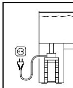
For din egen sikkerhet anbefales det å lage en dråpesløyfe på tilkoblingskabelen, som forhindrer at det renner vann langs kabelen til stikkontakten.
