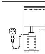
Voor uw eigen veiligheid is het aan te raden met de aansluitkabel een druiplus te vormen die voorkomt dat water langs de kabel loopt en in het stopcontact terechtkomt.
