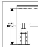
Bei der Wahl des Gerätestandortes auf die Aufstellhöhe achten. Um eine optimale Funktionssicherheit zu erzielen, dürfen zwischen Wasseroberfläche und Filterboden max. 180 cm liegen. Da bei der Holzverarbeitung eine Vielfalt von Lacken und Polituren verwendet werden, können die Gerätefüße sichtbare Rückstände auf Möbeln oder Parkettböden hinterlassen.
