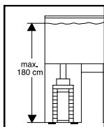
Let bij de plaatsing van het apparaat op de opstellhoogte. Voor een optimale werking mag tussen wateroppervlak en filterbodem maximaal 180 cm liggen.
