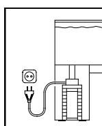
Pro vaši vlastní bezpečnost doporučujeme vytvořit s připojovacím kabelem odkapávací smyčku, která zabrání případnému stékání vody podél kabelu do sítové zásuvky.
