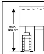
Vær opmærksom på opstillingshøjden, når enheden sættes op. For at opnå optimal funktionssikkerhed må der maks. være 180 cm mellem vandoverflade og filterbund.
