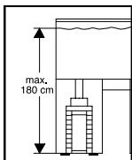
在选择设备安放地时，请注意安置高度。为了达到最佳的安全性能，应该允许水面与过滤器安放平面之间有最大 180 cm 的距离。
