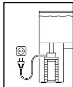
Oman turvallisuutesi vuoksi suosittelemme, että jätät sähköjohtoon tippamutkan, jotta akvaariosta mahdollisesti johtoa pitkin valuva vesi ei pääse pistorasiaan.
