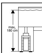
Tenga en cuenta la altura de instalación al escoger el lugar de ubicación del aparato. Para conseguir una seguridad óptima en el funcionamiento, puede haber un máximo de 180 cm entre la superficie del agua y el suelo del filtro.
