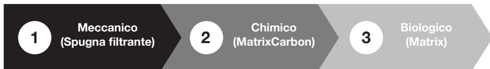
Fig 5: Posizionamento materiale filtrante (dal basso all'alto)
